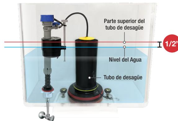
\*De lo contrario, podría agrietar la válvula de llenado o el tanque o producir una inundación. Asegúrese de que la taza flotante no toque las paredes del tanque, la palanca del tanque ni la válvula de descarga.
